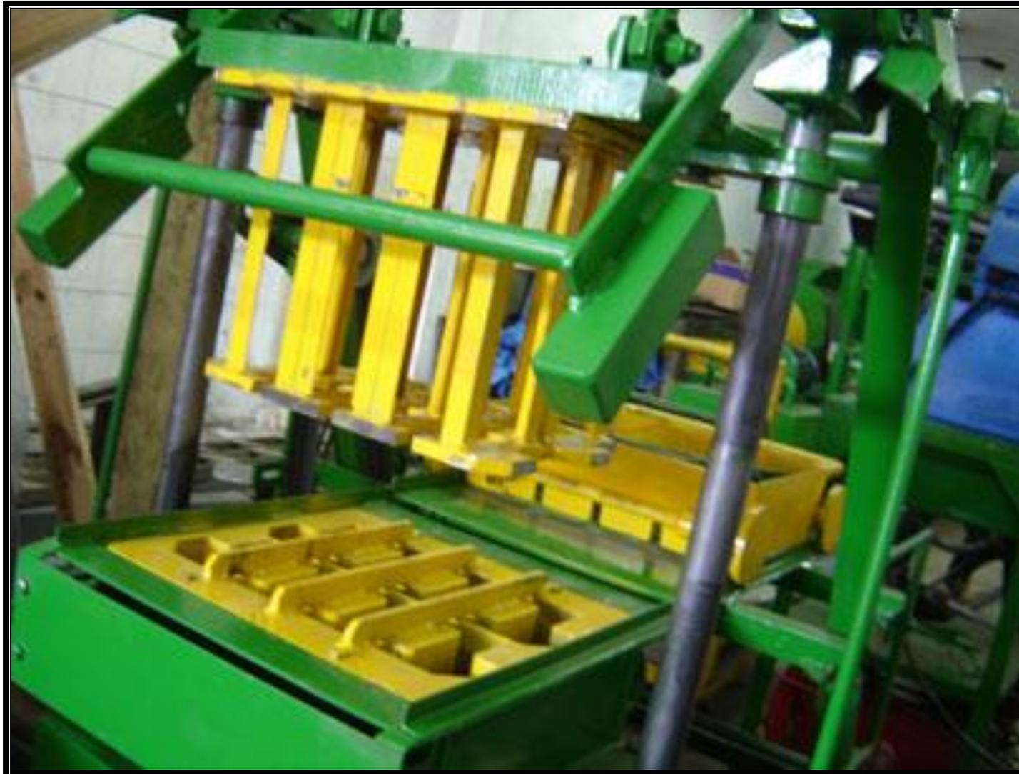
**MOULE HOURDIS Installé sur PRESSaBLOCS**
