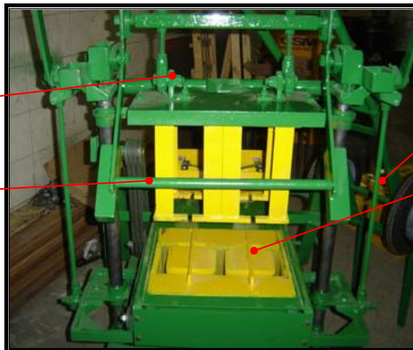
PRESSaBLOCS – ENSEMBLE – Vue de Face avec MOULE 20-C - Installé
