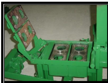
Photo de la Machine sans MOULE installé
